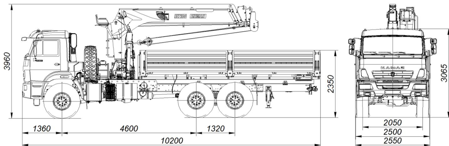
Размеры для автомобиля снаряженной массы: - с шинами 425/85R21
